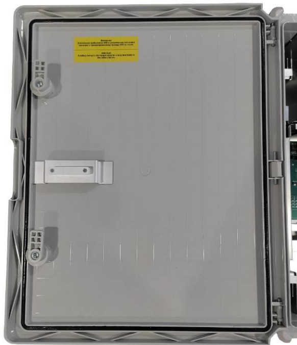
Рисунок 3.7.1 - Датчик вскрытия на крышке коммутатора
