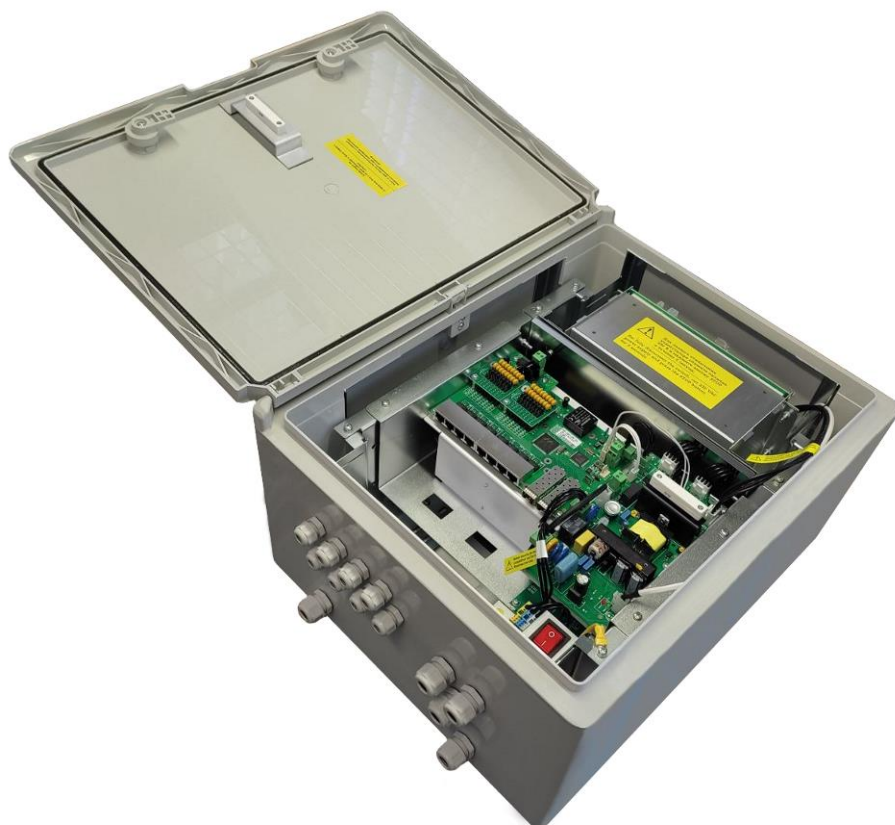
Рисунок 3.1.2 - PSW-2G8F+UPS-Box - вид внутри
