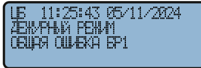
Рисунок 28. Отображение неисправности БР1–9 на ЖКИ ЦБ системы.
