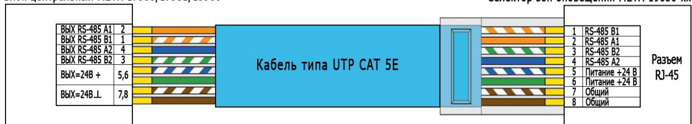
Рисунок 21. Схема подключения кабеля от СЗО МЕТА 19630-xx напрямую к клеммам «ВЫХ. RS-485-1», «ВЫХ. RS-485-2» и «ВЫХ=24В» ЦБ МЕТА 17950/17951/19960.
