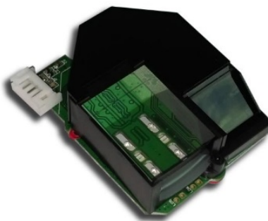
Внешний вид оптического сканера отпечатков пальцев FS81H
