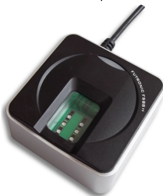
Внешний вид оптического сканера отпечатков пальцев FS81H
