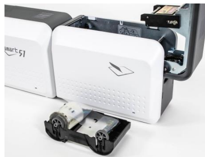
Рис. 22 Установите ламинационную ленту
