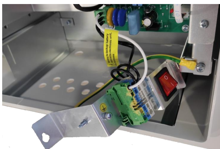
Рисунок 3.5.2 – Узел подключения питания освобожден от крепежа.
