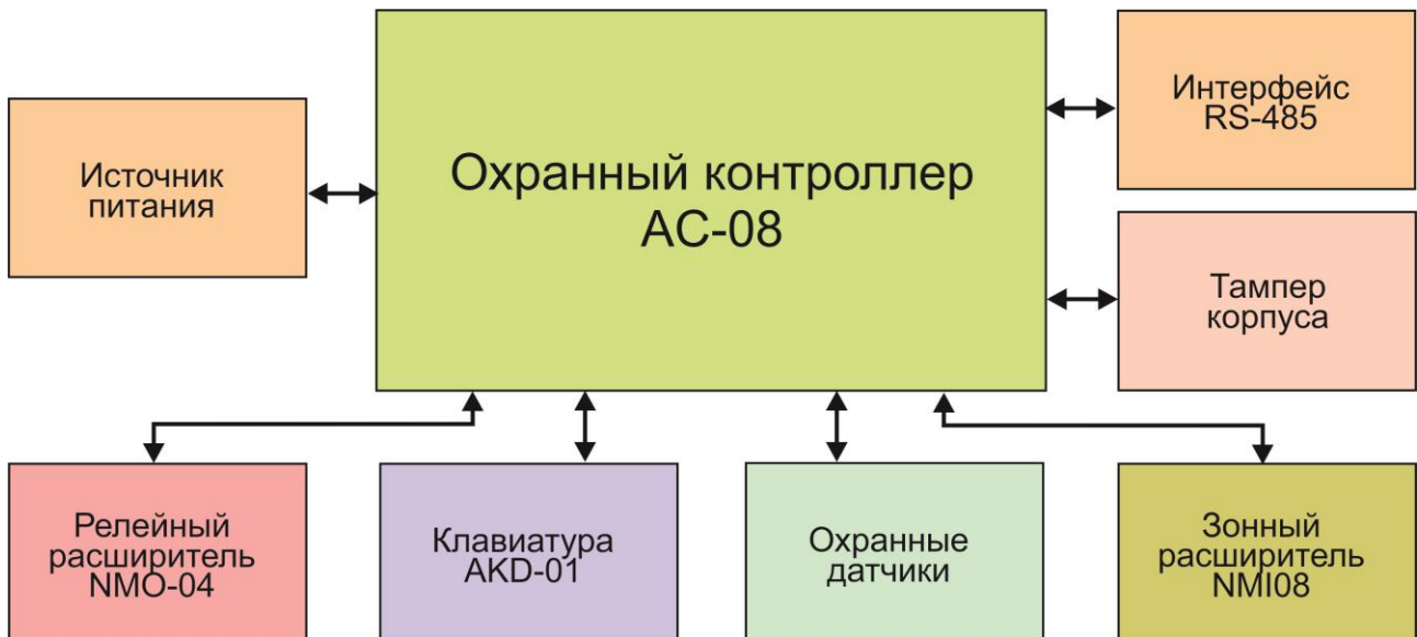
Рисунок 7. Оборудование, подключаемое к контроллеру AC-08
