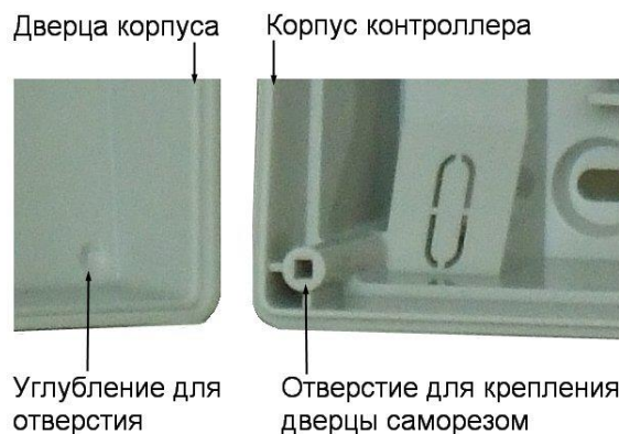
Рисунок 5. Схема «жесткого» крепления дверцы к корпусу контроллера
