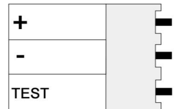
Рисунок 3. Назначение контактов разъема POWER
