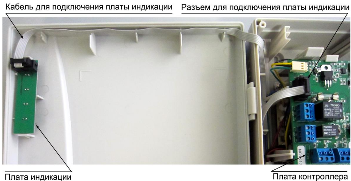
Рисунок 15. Схема подключения платы внешней индикации
