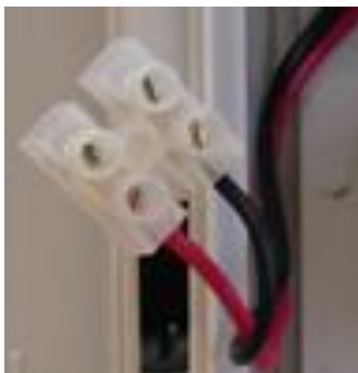
Рисунок 10. Клеммы для подключения дополнительного устройства к блоку питания
