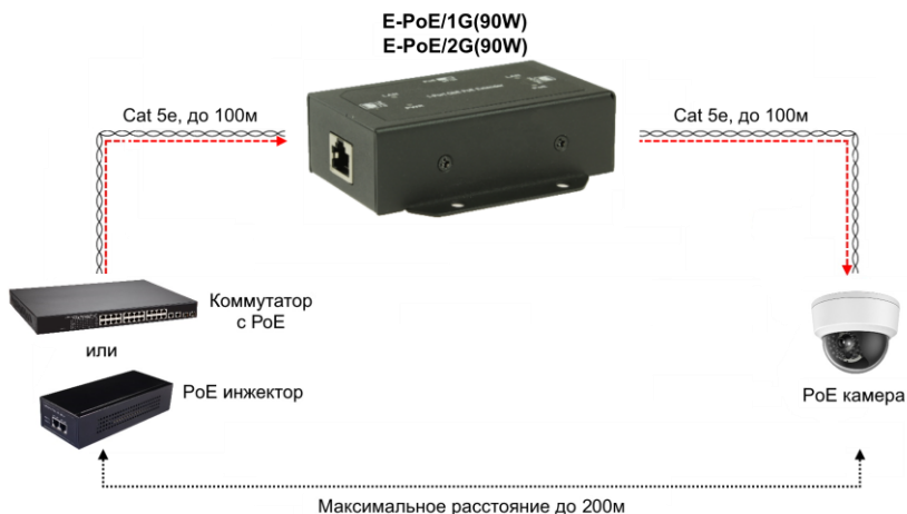
Рис.4 Схема подключения PoE удлинителей E-PoE/1G(90W), E-PoE/2G(90W)
