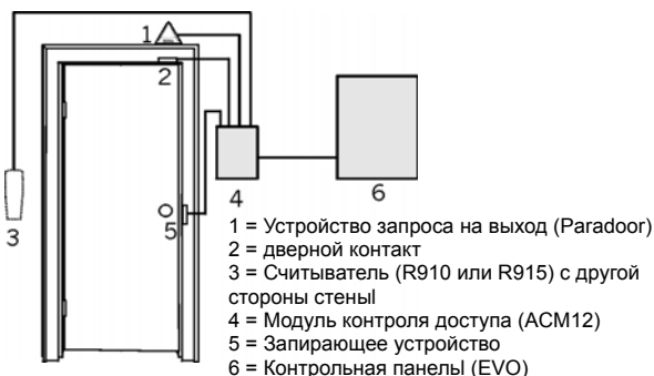
Рис. 19: Типовая установка контроля доступа*
