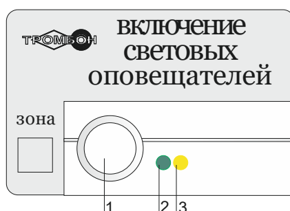
Рис. 3 Эскиз удалённого выключателя светового оповещения «Тромбон ВСО»
