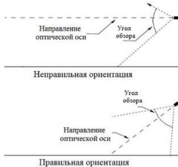
Рисунок 4 – Установка извещателя по отношению к горизонту.
