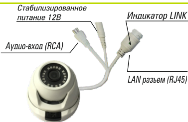
Рис. 1 Схема подключения видеокмеры
