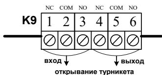
Пример 5. Подключение турникета (турникетный режим)
