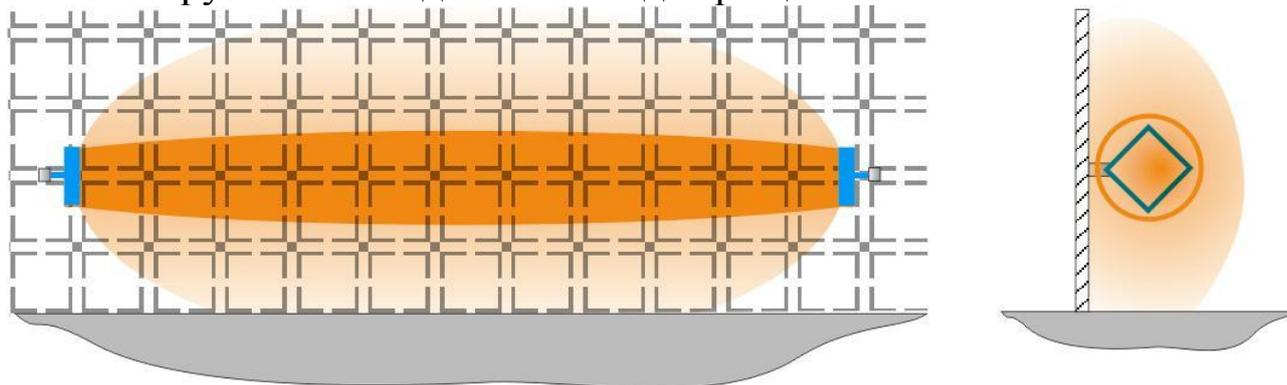
Сигналы отраженные от заграждения, снежного покрова, столбов, стен зданий или других вертикальных и горизонтальных предметов, попадают на приемную антенну под углом ( $\sim 90^\circ$ ) по отношению к ее собственному вектору поляризации, практически «не видимы» и не создают интерференции.
