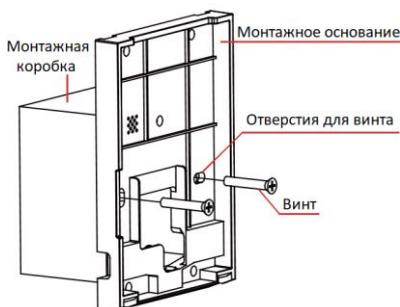
Рисунок 4-1 Установка монтажного основания
