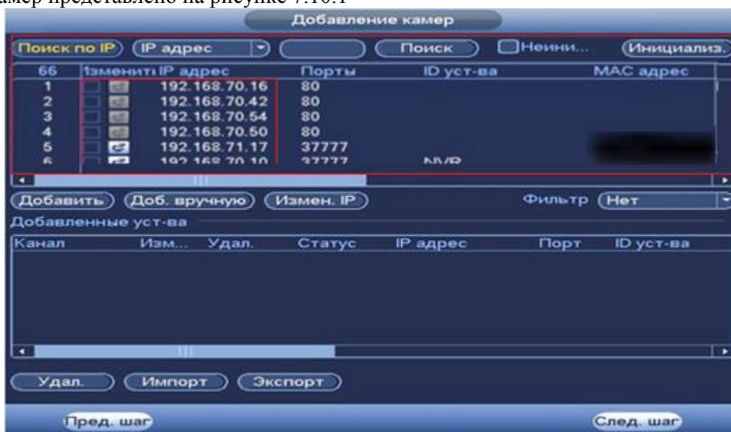
Рисунок 7.10.1 Настройка добавления камер по поиску в сети.
