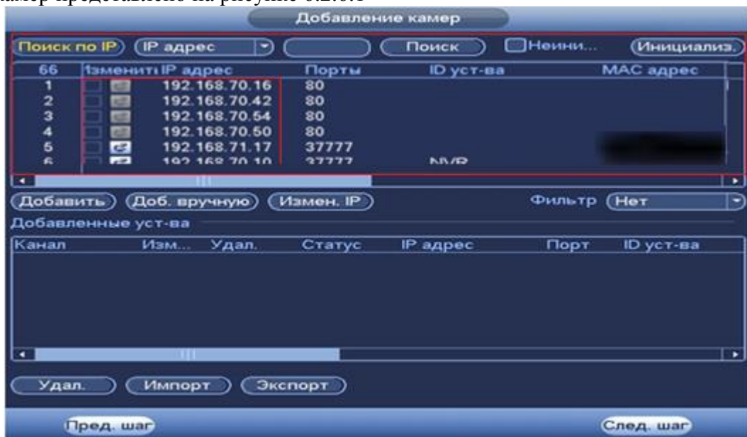
Рисунок 6.2.6.2 Настройка добавления камер по поиску в сети.
