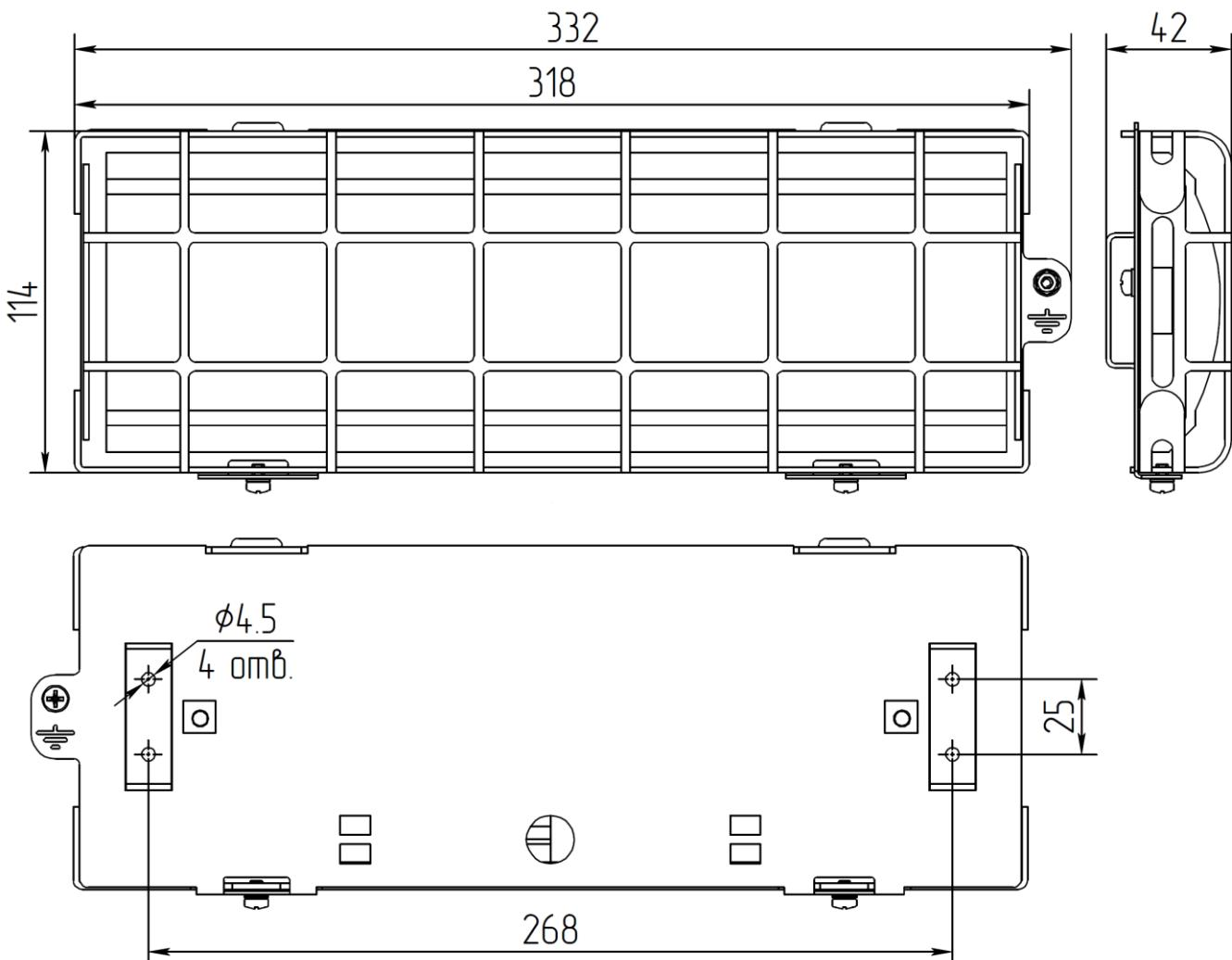
**Габаритные и установочные размеры оповещателя светового ОС**
