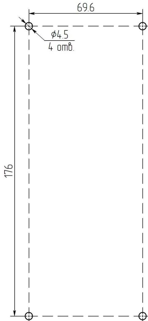
**Габаритные и установочные размеры выносного элемента ЭВ**
