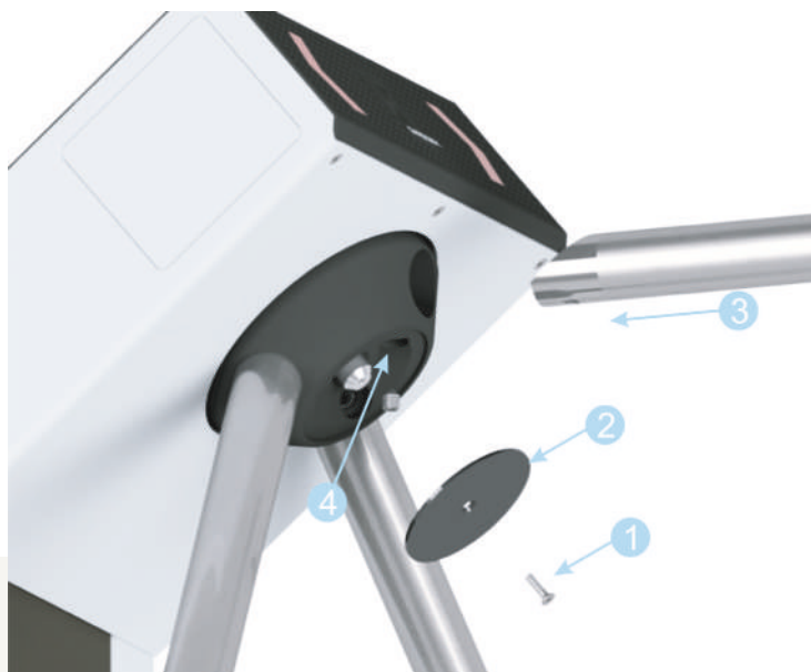
Рисунок 7.5.1 - Установка стандартной преграждающей планки
