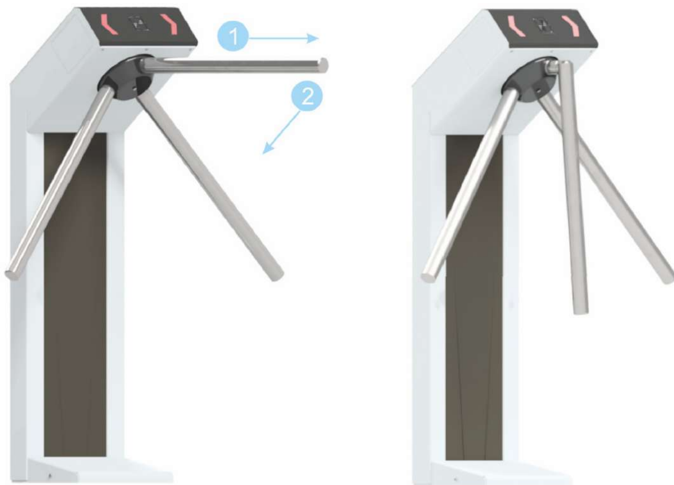
Рисунок 6.5.3 – Принцип работы планок «Антипаника».
