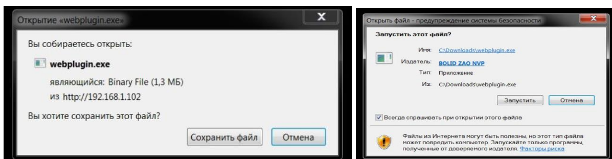
Рисунок 7.1 – Установка плагина для подключения к web-интерфейсу
