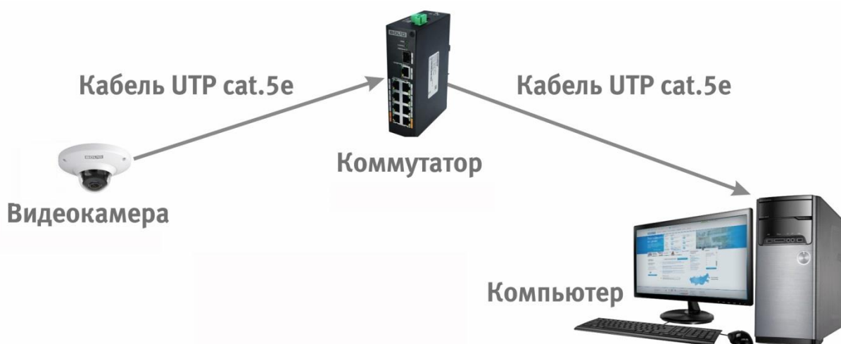
Рисунок 6.3 - Схема подключения видеокамеры к компьютеру через коммутатор
