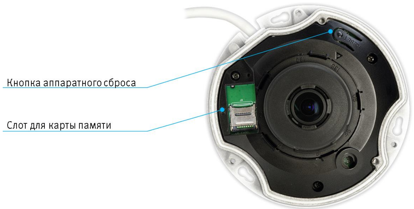
Рисунок 4.2 – Расположение кнопки аппаратного сброса и слота для карты памяти
