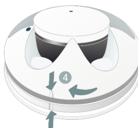
Рисунок 9.2 – Закрепление корпуса датчика
