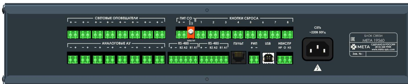
Рисунок 3. Элементы коммутации (клеммы/разъемы) БС МЕТА 19560.
