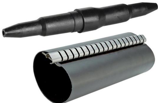
Разветвительные муфты с манжетами ТУМ предназначены для восстановления оболочек на кабелях ТППЭп, ТППпЗП, ТППЭпЗ и т.д. Муфты, смонтированные с использованием термоусаживаемых манжет, могут устанавливаться под постоянное избыточное воздушное давление. Подбор разветвительных муфт с ТУМ следует производить с учетом ёмкости сращиваемых кабелей, типоразмера муфты и типов используемых соединителей.
