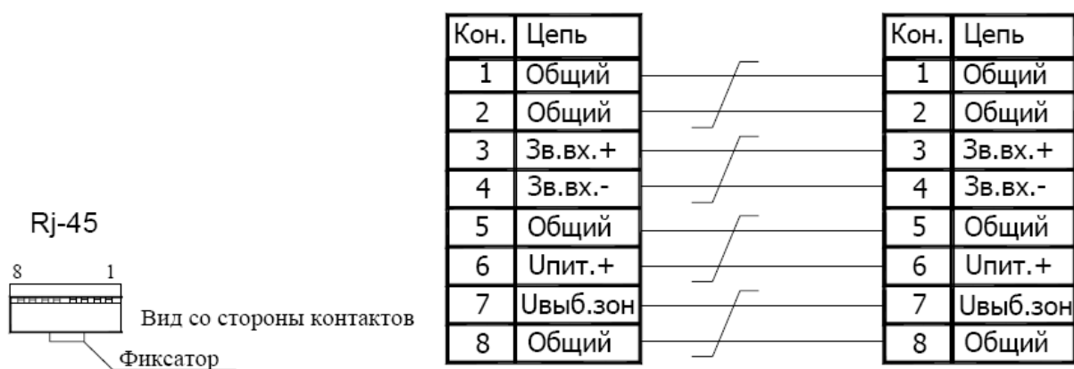
Рис.2 Схема соединения кабеля Нумерация контактов разъема Rj-45 условная.
