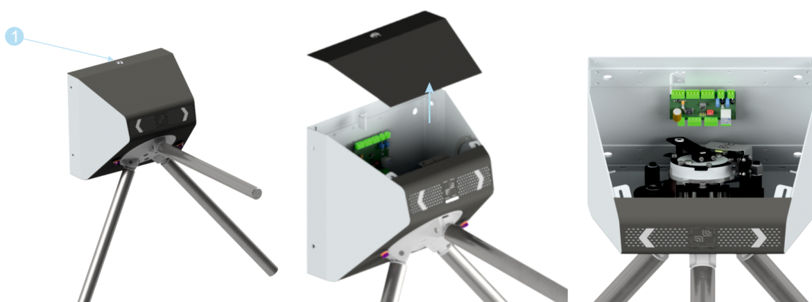
Рисунок 12.1.1. Демонтаж верхней крышки турникета.
