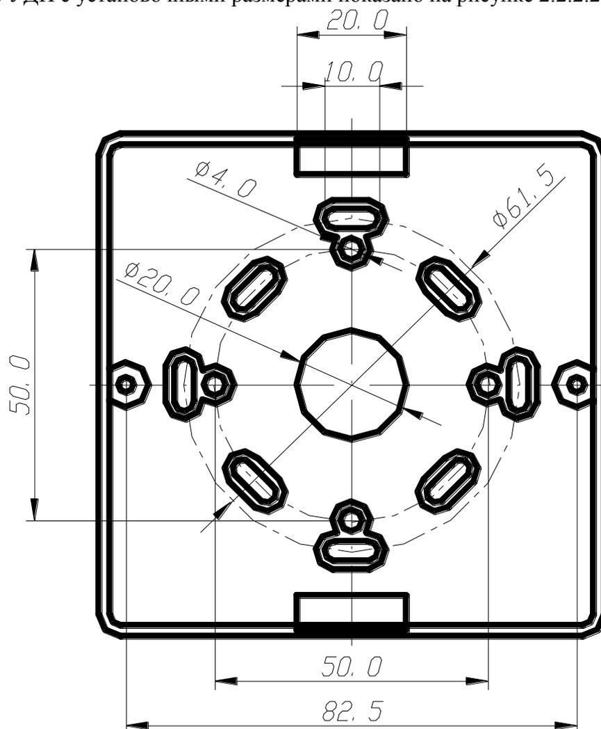
Рисунок 2.2.2.2 Установочные размеры УДП
