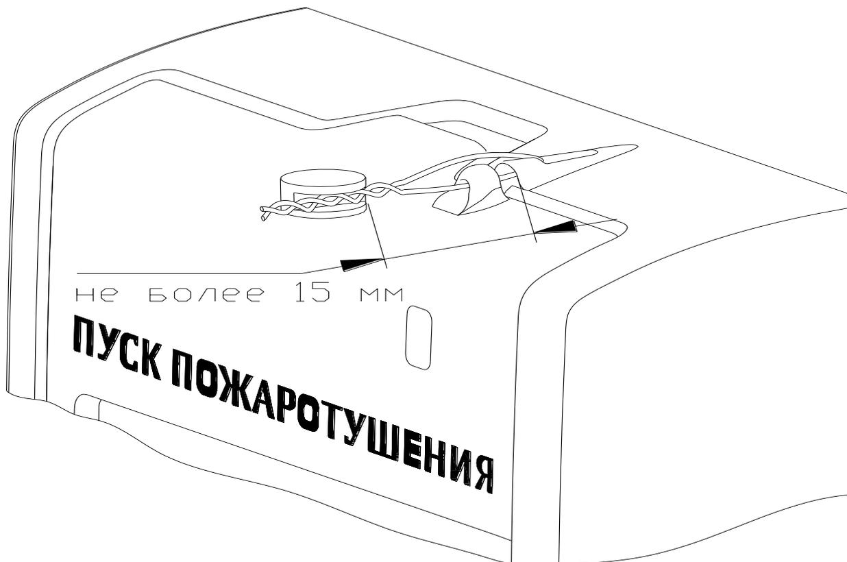
Рисунок 2.2.3.2 Пломбировка УДП
