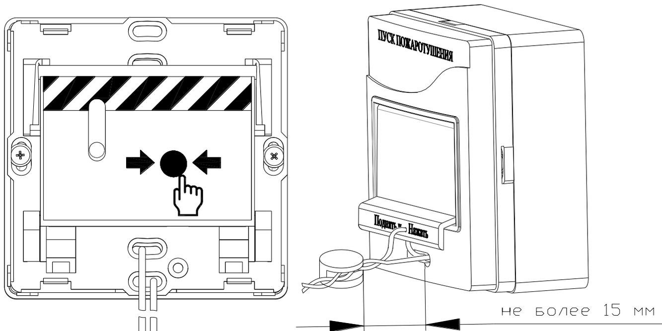
Рисунок 2.2.3.2 Пломбировка УДП
