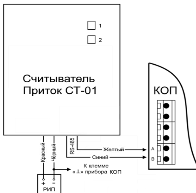
Рисунок 8 - Схема подключения
