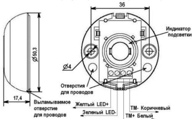
Рисунок 1 – Общий вид платы, присоединительные размеры
