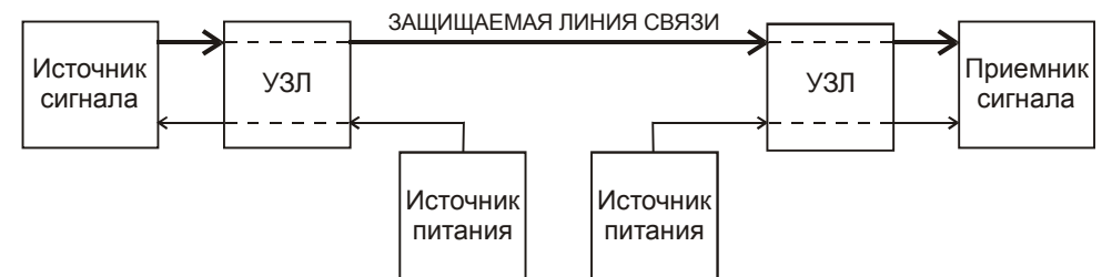
Рис.3. Структурная схема подключения ASP-1-12/24.
