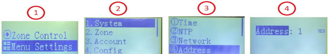
Рисунок 7.8 Установка номера шины
