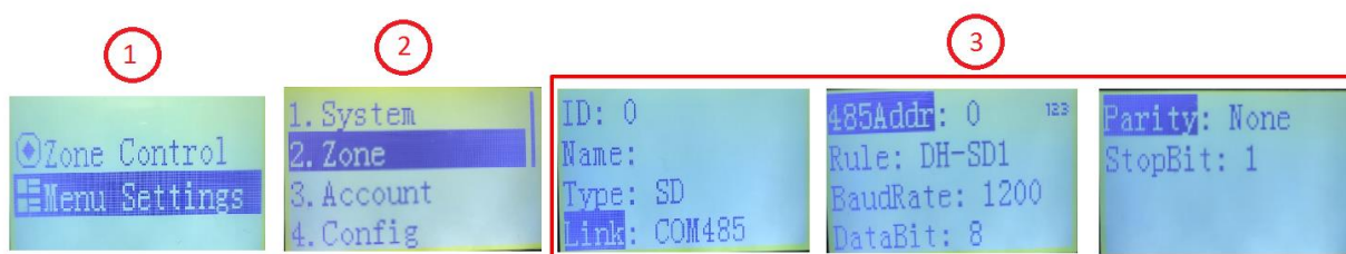
Рисунок 7.4 Настройка контрольной точки через RS-485
