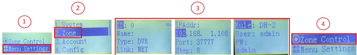
Рисунок 7.1 Установка зоны на пульте для подключения к регистратору через сетевой порт
