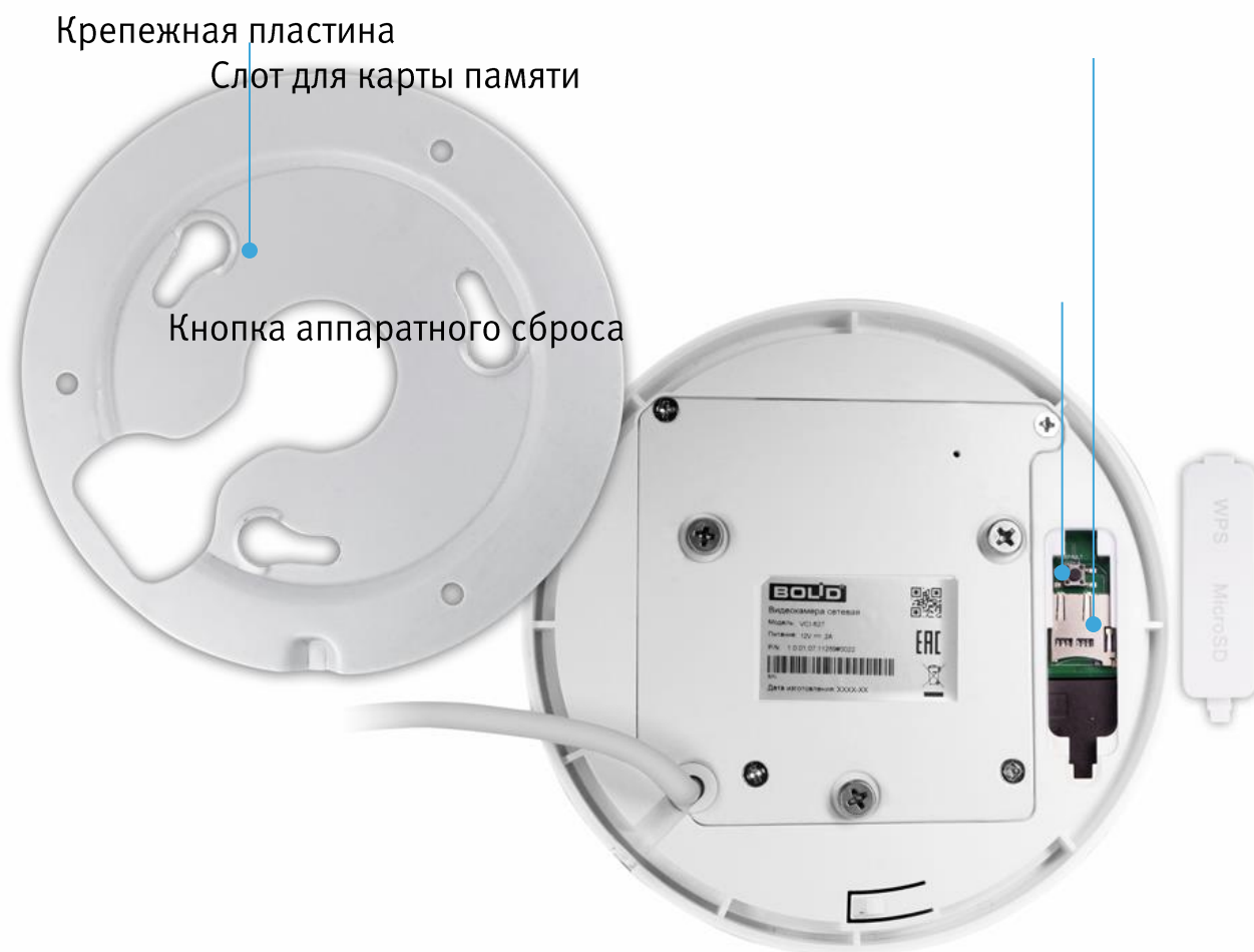
Рисунок 4.2 – Расположение кнопки аппаратного сброса и слота для карты памяти
