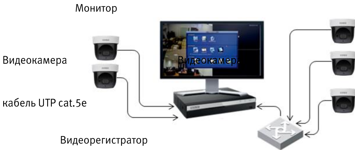
Рисунок 6.4 – Схема подключения видеокамеры к видеорегистратору
