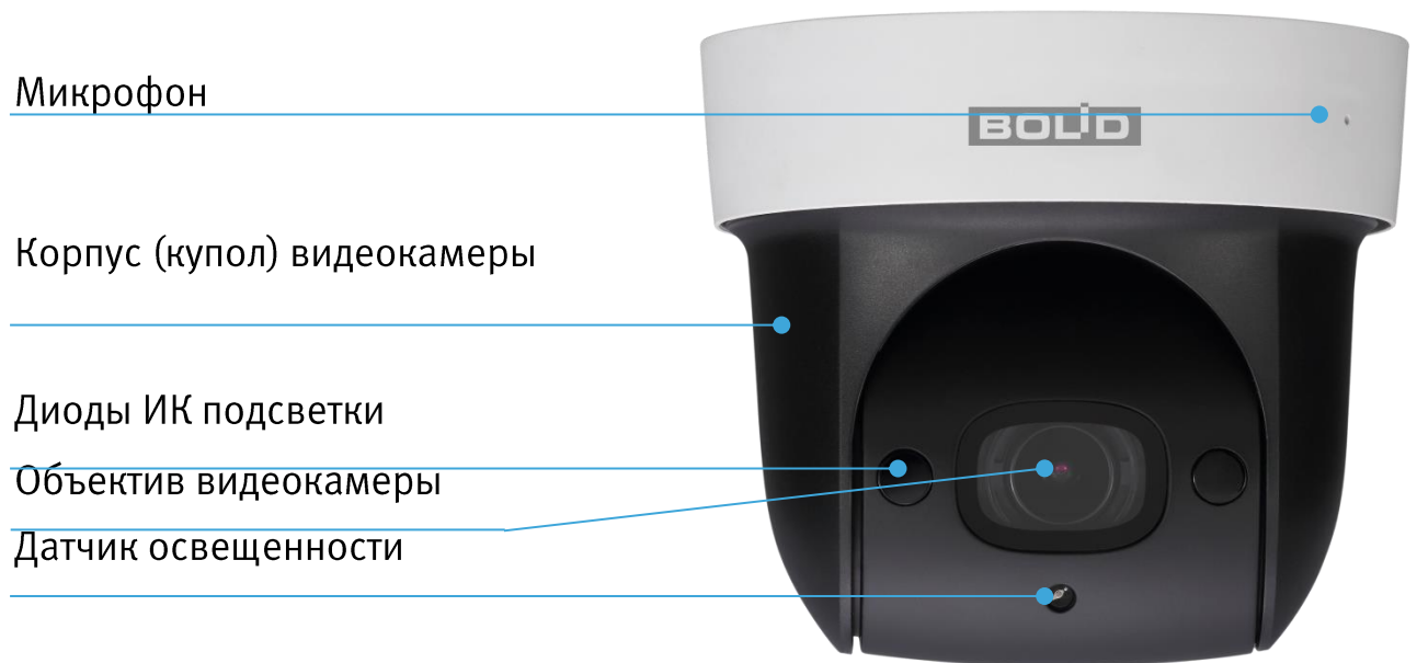
Рисунок 4.1 – Внешний вид и основные элементы видеокамеры
