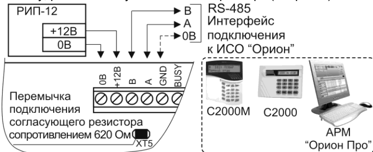
Рисунок 4. Схема подключения по интерфейсу RS-485
