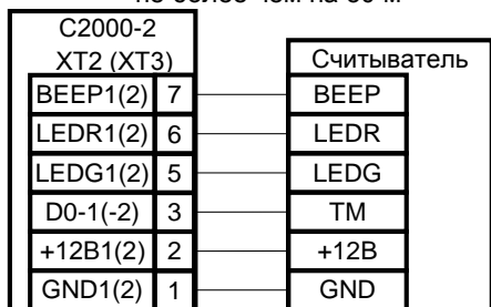
Рисунок 11. Схема подключения считывателей с интерфейсом Touch Memory
