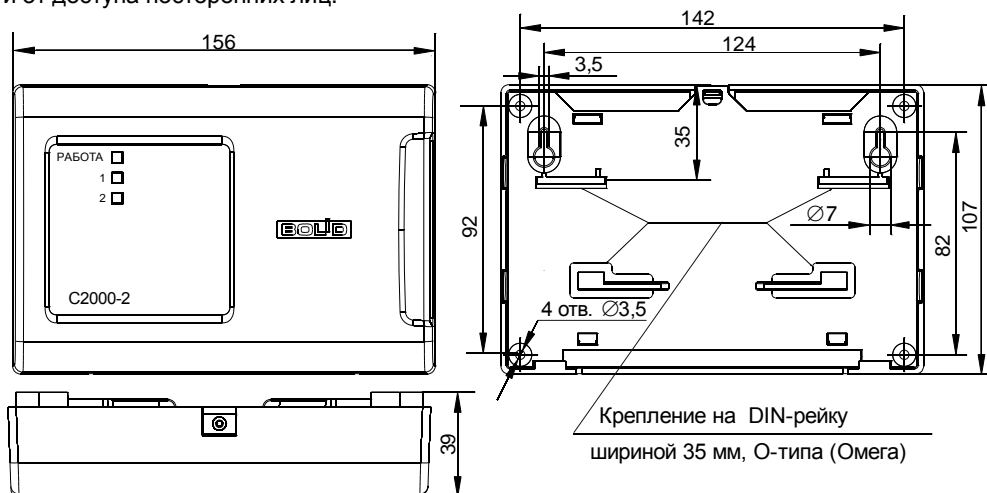
Рисунок 1. Габаритные и установочные размеры контроллера
