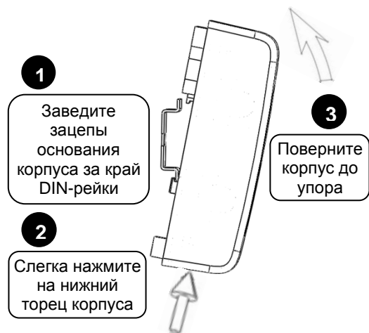
Рисунок 3. Крепление контроллера на DIN-рейку
