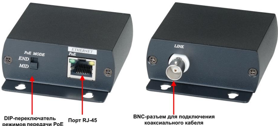
Рис. 2 Приемопередатчик IP01P, расположение разъемов
