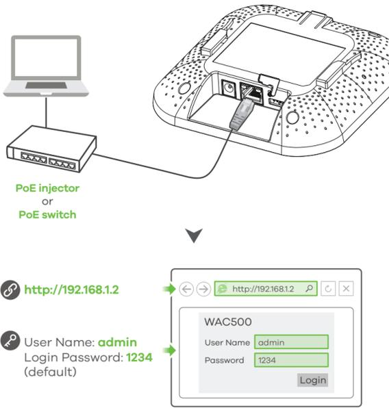
**SE 1-b** Använd en Ethernet-kabel för att ansluta en dator till WAC500 **UPLINK-port** via en PoE-injektor eller PoE-omkopplare. Använd den DHCP-tilldelade IP- eller statiska IP-standardadressen "http://192.168.1.2" för att öppna webbkonfiguratoren. Kontrollera att datorns IP-adress finns i samma delnät som WAC500.
