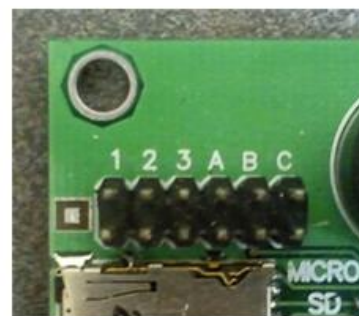
Рис. 5.1. Перемычки на NV DG/DT 2010
