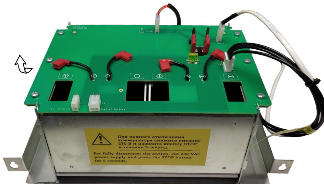
Рисунок 7.6 – Отсек с установленными АКБ.
