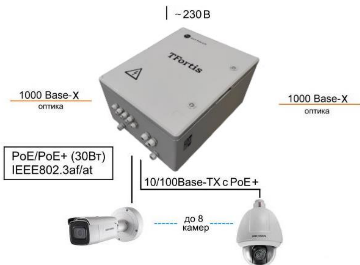
Рисунок 1 - Схема подключения PSW-2G8F+UPS-Box
