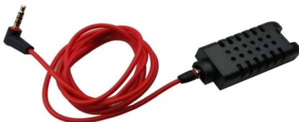
Рис.1 Коммутатор SW-81602/ILS(port 90W, 600W), датчик температуры/влажности с кабелем для подключения к коммутатору (внешний вид)
