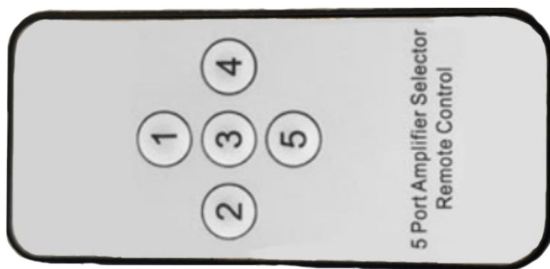
Рис. 4 ИК Пульт управления HDMI коммутатором SW-Hi5012, обозначение кнопок
