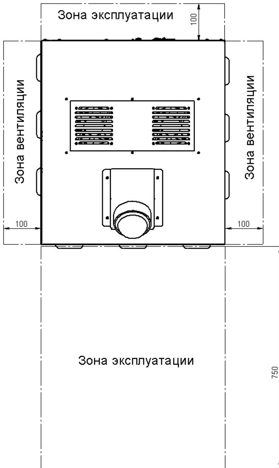
Рисунок 4. Зони експлуатації и вентиляції
