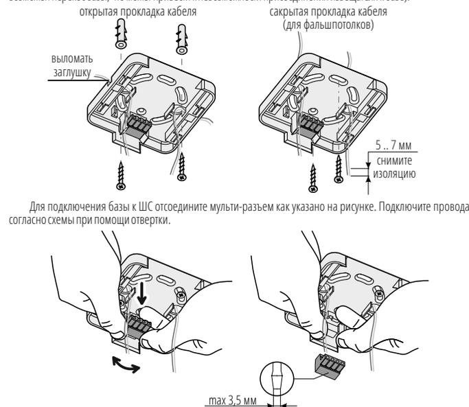
Для подключения базы к ШС отсоедините мульти-разъём как указано на рисунке. Подключите провода согласно схемы при помощи отвертки.
