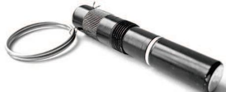
Узлы с ручным запуском ВУД вкручиваются в посадочное гнездо на корпусе генератора и запускаются вручную. Запуск осуществляется при помощи рывка кольца. Специальный состав внутри узла запуска обеспечивает задержку срабатывания до 9 секунд (задержка необходима для обеспечения безопасности забрасывания генератора в горящее помещение). Предназначены для запуска генератора переносного типа АГС-15.
