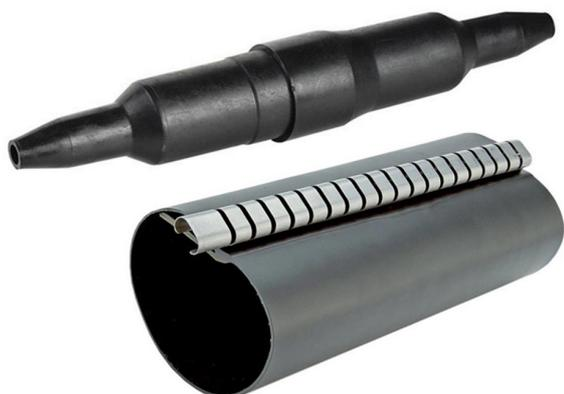
Разветвительные муфты с манжетами ТУМ предназначены для восстановления оболочек на кабелях ТППЭп, ТПппЗП, ТППЭпЗ и т.д. Муфты, смонтированные с использованием термоусаживаемых манжет, могут устанавливаться под постоянное избыточное воздушное давление. Подбор разветвительных муфт с ТУМ следует производить с учетом ёмкости сращиваемых кабелей, типоразмера муфты и типов используемых соединителей.
