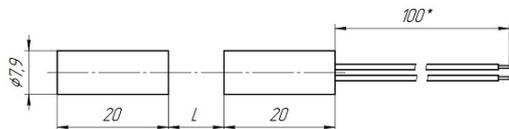
Рис.1 Габаритные размеры.
