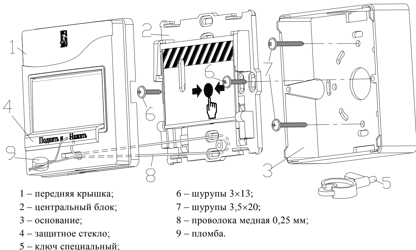
Рисунок 2.2.3.1 Части конструкции УДП
