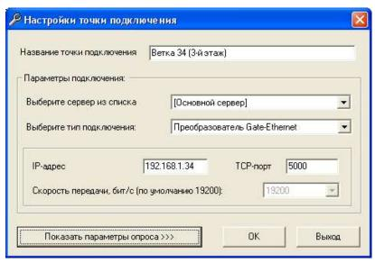
Выберите тип подключения «Преобразователь Gate-Ethernet» и укажите IP-адрес и ТСР-порт преобразователя, которые были присвоены ему ранее с помощью утилиты конфигурации. (В случае подключения по СОМ-порту нужно будет указать только номер порта)
