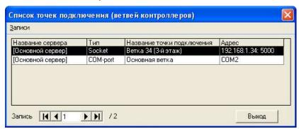
Для каждого преобразователя Gate-Ethernet (также, как и для каждого COM-порта) должна быть создана отдельная точка подключения.
