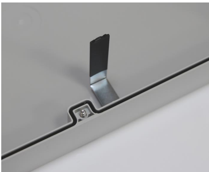
Рисунок 3.5.2 - Шторка датчика вскрытия на крышке блока
