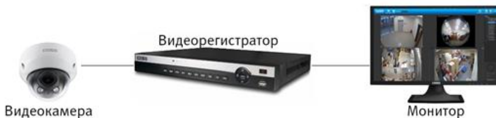
Рисунок 6.2 – Схема подключения видеокамеры
