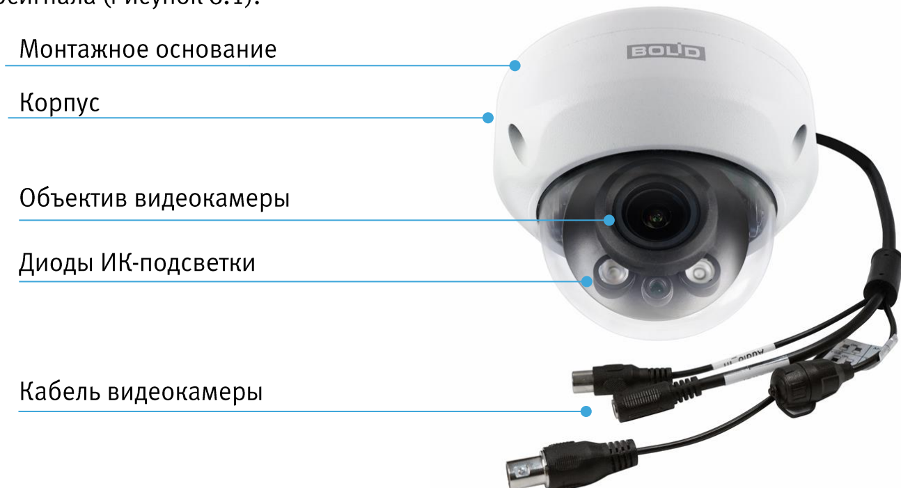
Рисунок 4.1 - Внешний вид и основные элементы видеокамеры
