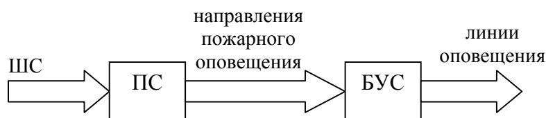
Рисунок 6.6. Сущности пожарного оповещения.
