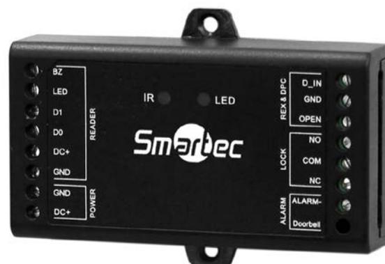
Автономный контроллер ST-SC011 предназначен для построения независимой системы контроля доступа с управлением одной дверью. Этот контроллер используется совместно с внешним считывателем, при этом считыватель устанавливается снаружи, а контроллер – внутри защищаемого помещения, за счет чего обеспечивается более высокий уровень безопасности.
