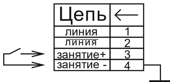
Рис. 1.12 Разводка разъема для подключения к линейному входу ГО
