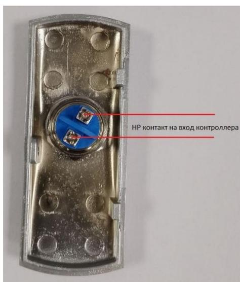
4. Установить кнопку на монтажное основание и затянуть винтом.
