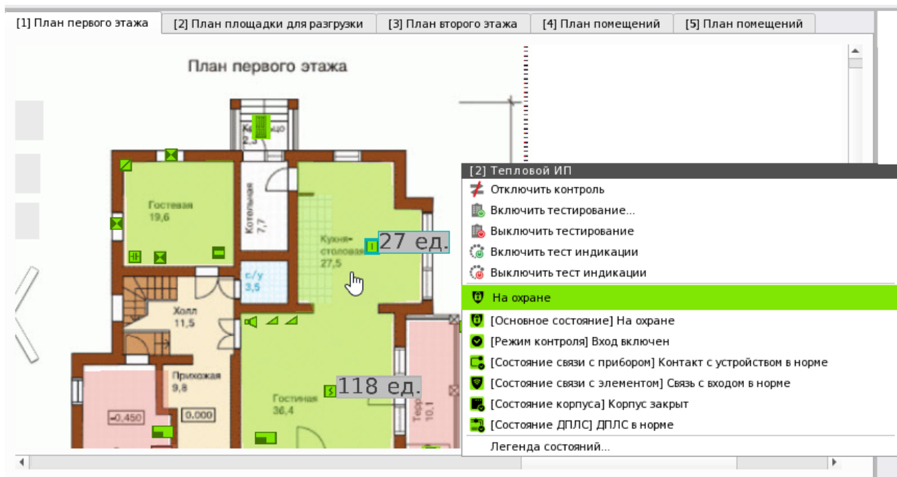
Рис.116 Пример контекстного меню для входа в дежурном состоянии
